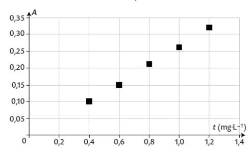
**4.** On trace la droite horizontale qui correspond à la valeur d'absorbance A=0,175. Cette droite coupe la courbe d'étalonnage en un point dont l'abscisse correspond à la concentration massique en bleu patenté de la solution d'Alodont :  $t_{Alondont} \approx 0,66 \text{ mg} \cdot \text{L}^{-1}$ .
