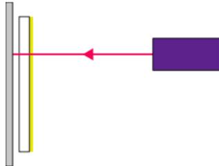
3. Lorsque le faisceau traverse des pigments minéraux avec du plomb, il ne parvient pas à la plaque sensible. On observera des zones blanches sur la plaque.
