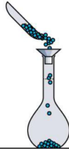
Vider le contenu de la coupelle dans une fiole jaugée de 100 mL en utilisant un entonnoir à solide.
