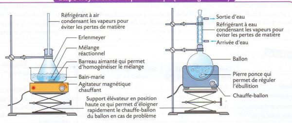
À la fin de la synthèse, refroidir le milieu réactionnel (en gardant la circulation d'eau dans le réfrigérant à eau) pour condenser les vapeurs éventuellement toxiques ou pour favoriser la précipitation d'un solide.
